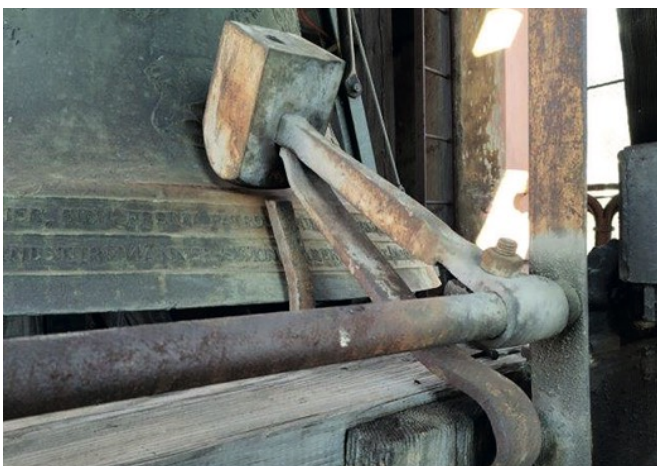
Schlaghammer der „großen“ Glocke („Heimkehrerglocke“)
